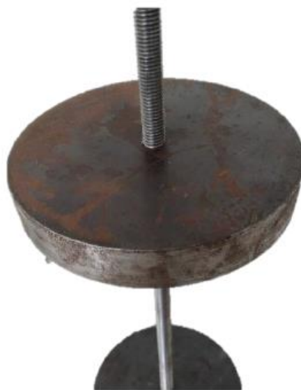
Gambar 4.2 Silinder besi dan ulir untuk memodelkan ballast
