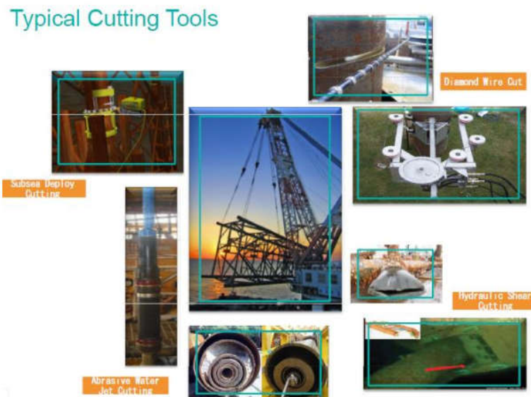
Gambar 2.5. Metode Cutting dalam Decommissioning (Baheshti, 2014)
