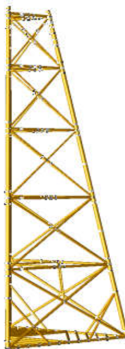
Gambar 4.7. Model Jacket pada SACS (Isometric)
