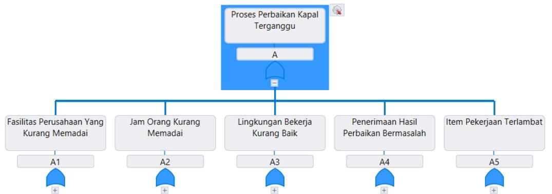
**Gambar 4.2** Diagram FTA Proses Perbaikan Kapal Terganggu
