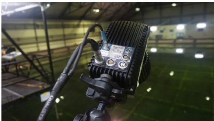
Gambar 4. 14: Qualysis Motion Capture Camera yang sudah dipasang
