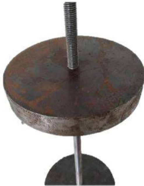
Gambar 4. 4: Silinder besi dan ulir untuk memodelkan ballast
