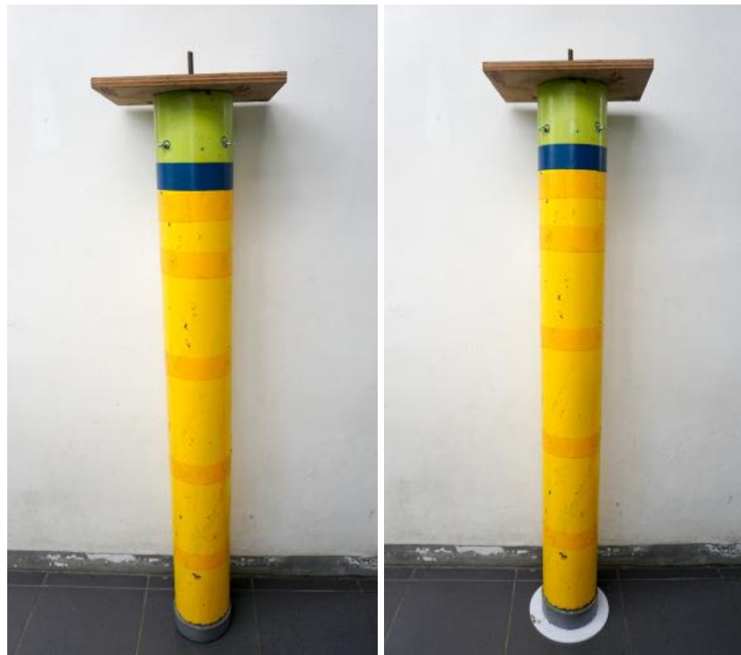
Gambar 4. 1: Hasil akhir model dengan dan tanpa heave plate
