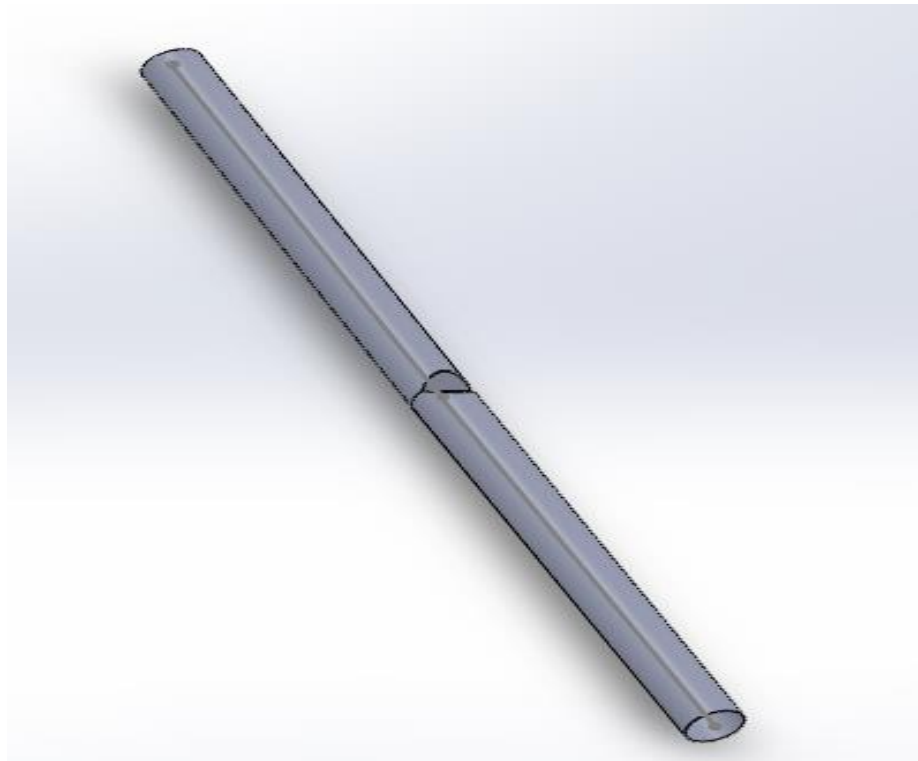
Gambar 3.7 Tubular Member yang sudah terkena dent .
