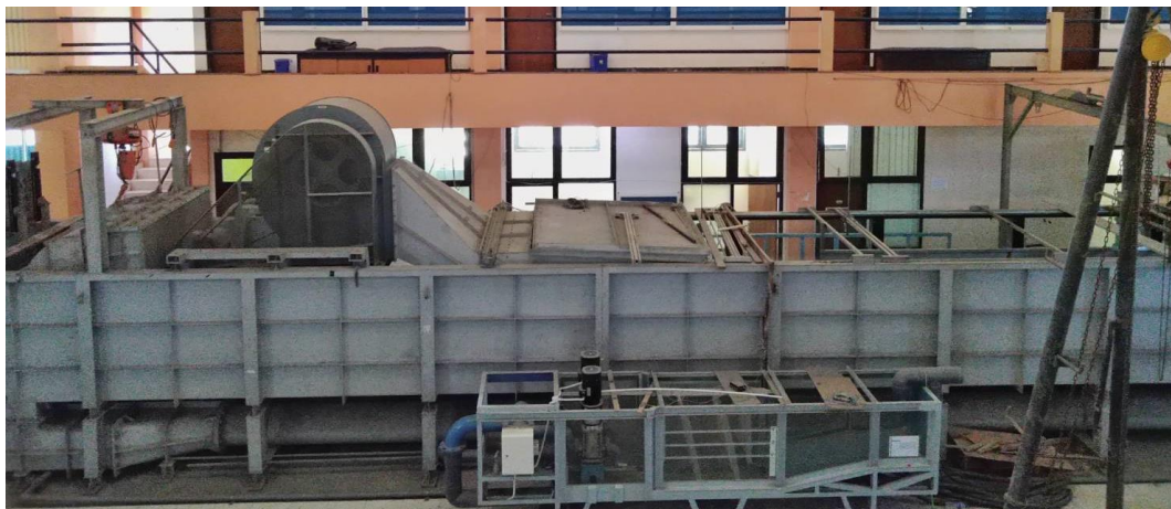
Gambar 3.5 Wave flume laboratorim rekayasa energi dan lingkungan
