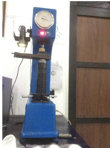
Gambar 3. 5 Alat Uji Kekerasan Micro Vickers
