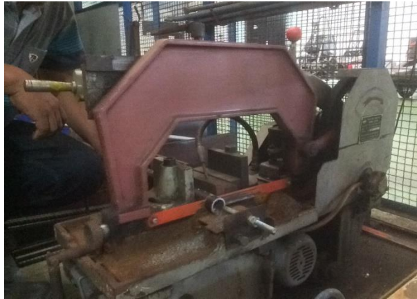
Gambar 3. 3 Proses Pemotongan Spesimen Uji
