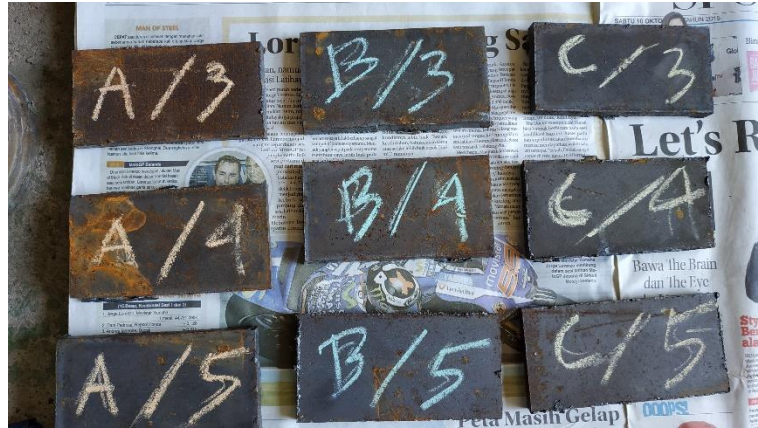
Gambar 3.2 Dimensi spesimen 12 \times 6 \times 1 cm
