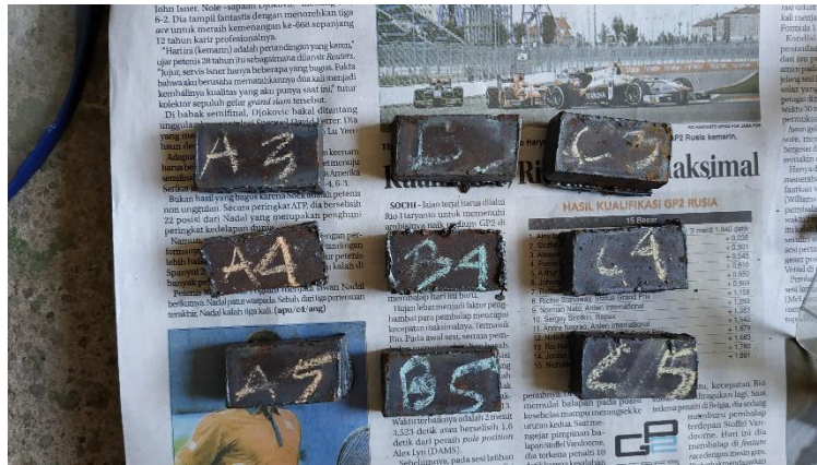
Gambar 3.3 Dimensi spesimen 4 \times 2 \times 1 cm.
