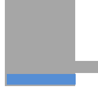
Gambar 2.1 Contoh konstruksi yang berpotensi mempercepat terjadinya korosi, akibat adanya endapan (Daerah biru)
