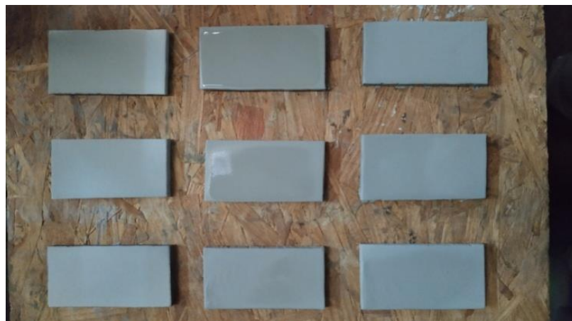
Gambar 4.4. Hasil Proses Coating Spesimen Adhesi
