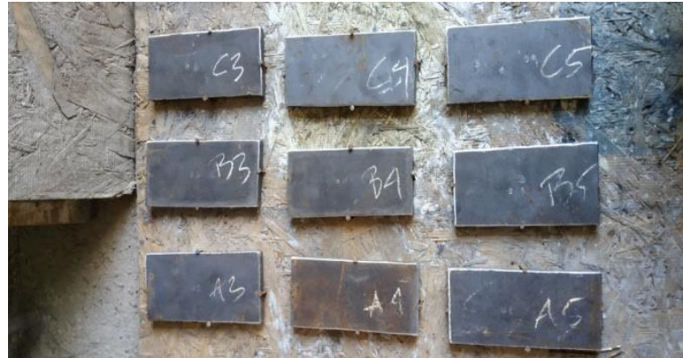
Gambar 4.1. Spesimen A36 Sebelum Dilakukan Blasting
