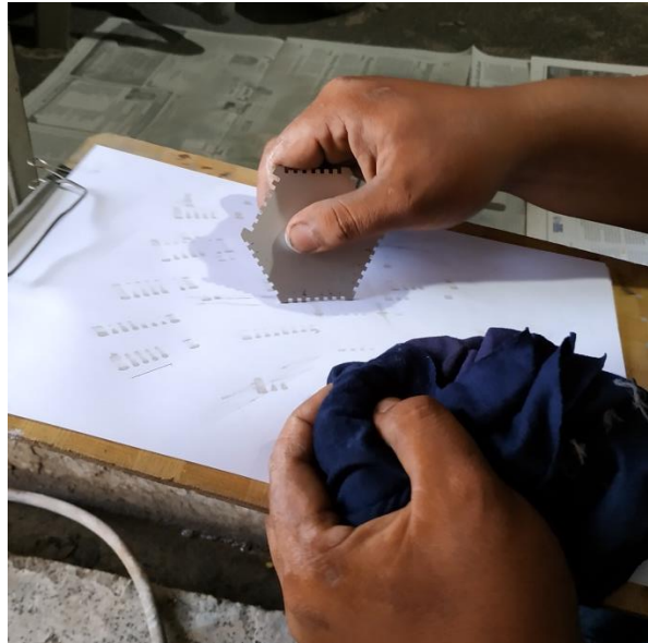
Gambar 3.10 Pengukuran ketebalan cat basah menggunakan wet film comb .
