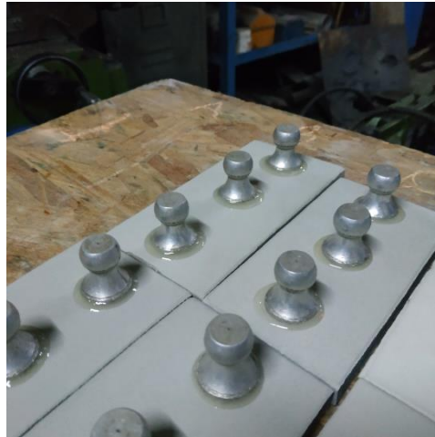
Gambar 3.12 Penempelan Dolly pada spesimen
