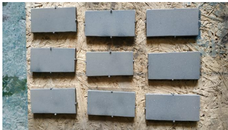
Gambar 4.2. Spesimen A36 Setelah Dilakukan Blasting
