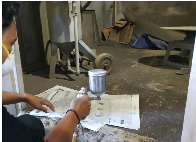
Gambar 3.9 Proses pengaplikasian Coating
