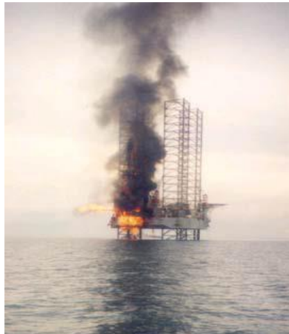
Gambar 2.3 Terjadinya Blowout pada platform offshore [5]
