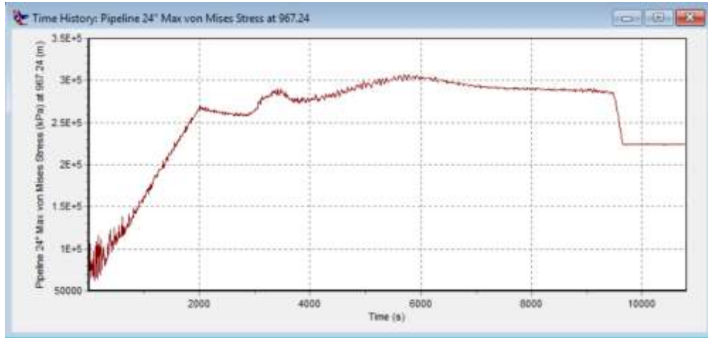
Gambar Output Max. Von Mises Stress Pipa Bagian Haluan ( Overbend ) Pembebanan 90° Sepanjang Waktu Pembebanan (10800s)
