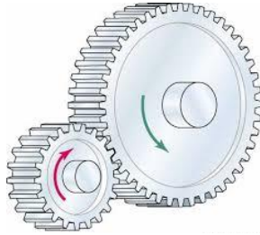
Gambar 2.3 Pasangan Roda Gigi Lurus (Wahyu, 2015)
