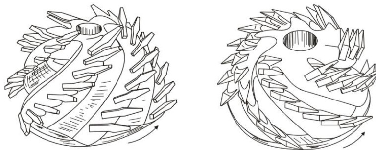
Gambar 2.3 Jenis Cutter Head (sumber : Vlasblom, 2005)
