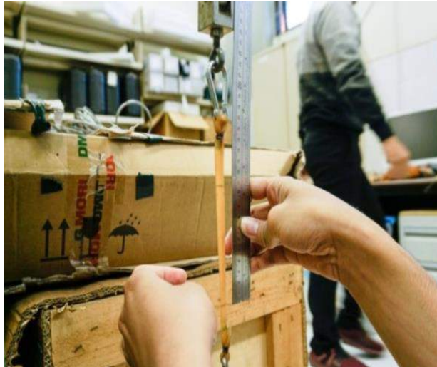
Gambar 3.15 Uji Kalibrasi Kekakuan Tali Tambat Karet Akibat Pembebanan (sumber: Dokumentasi Pribadi, 2019)
