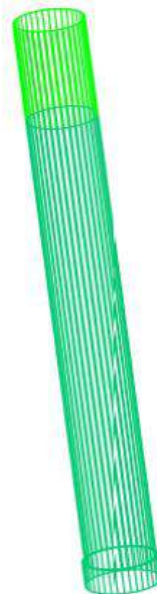
Gambar 3.4 Visualisasi Model Classic SPAR Pada Software MOSES
