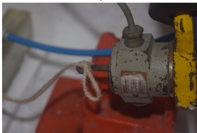
Gambar IV.4 Pengikatan Loadcell menggunakan Tali
