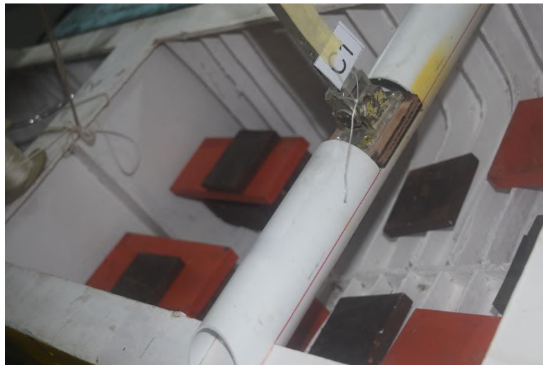
Gambar IV.1 Penempatan Pemberat di Sepanjang Badan Model Kapal
