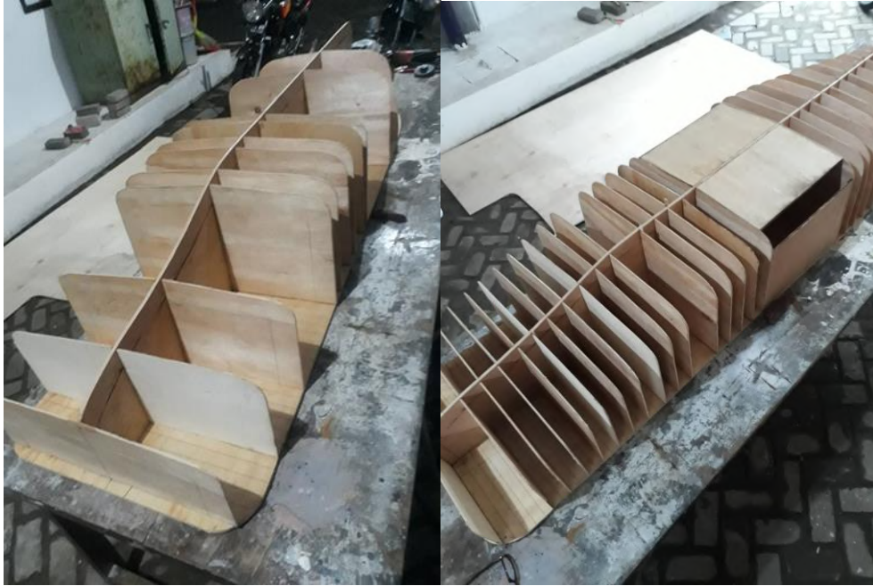
Gambar III.7 Hasil Assembly Menggunakan Perekat
