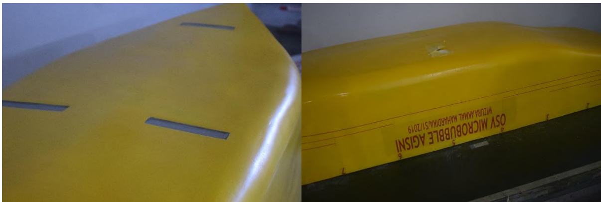
Gambar 11 Pengecatan, pemasangan stiker, pemberian garis air dan garis station, dan pemasangan turbulence stimulator
