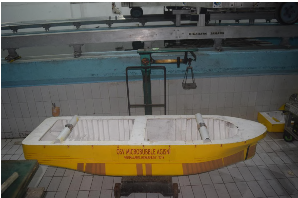
Gambar 12 Pemasangan holder, dan pengukuran dimensi berat panjang lebar
