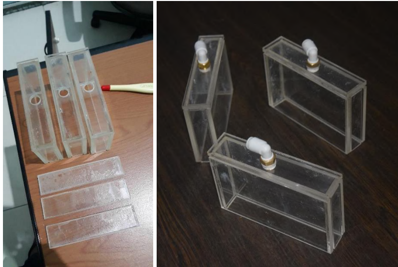
Gambar III.10 Case dari Injektor
