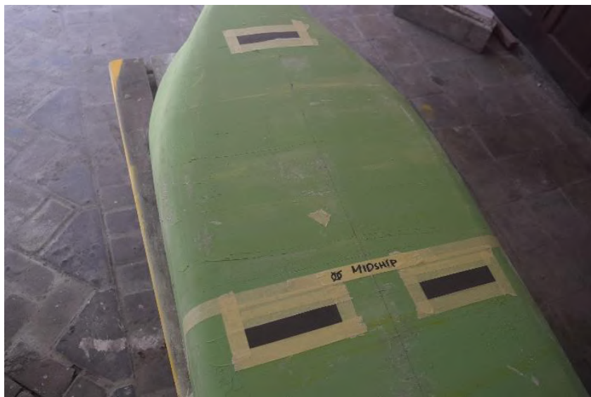
Gambar III.8 Penandaan Bagian yang akan Dipotong
