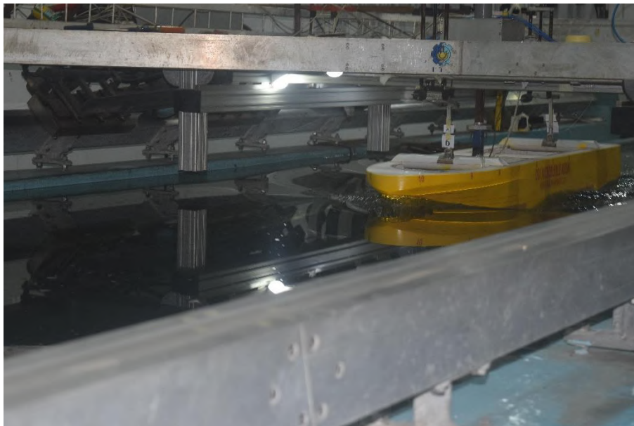
Gambar 14 Pengujian tanpa gelembung A-1 (konversi skala 6 knot)
