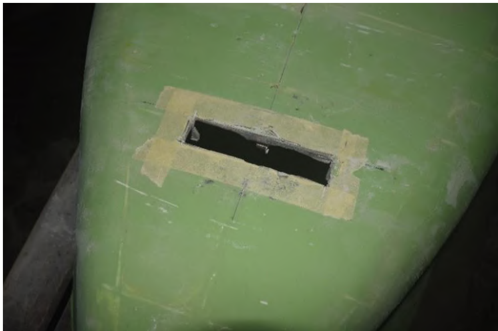
Gambar III.9 Lubang yang Dibentuk pada Lambung Kapal
