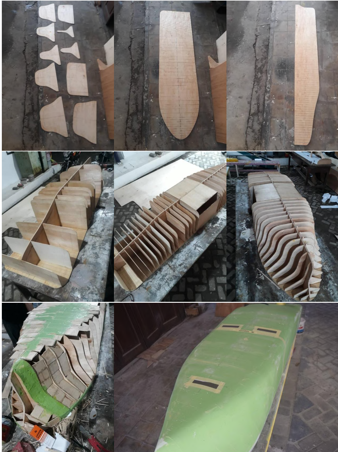
Gambar 9 Fabrikasi model kapal hingga siap rakit
