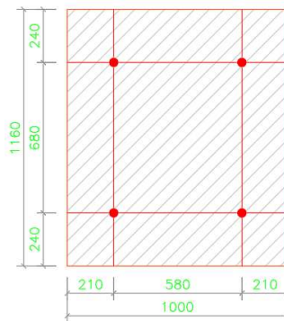
Gambar 5. 11 Letak titik angkat pelat precast
