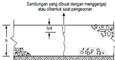
Gambar 2.29 Sambungan Susut Melintang Tanpa Ruji
