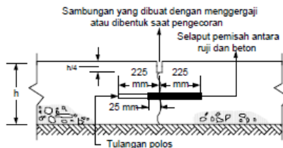
Gambar 2.30 Sambungan Susut Melintang Dengan Ruji
