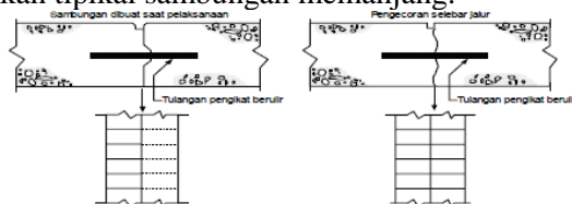
Gambar 2.27 Tipikal Sambungan Memanjang
