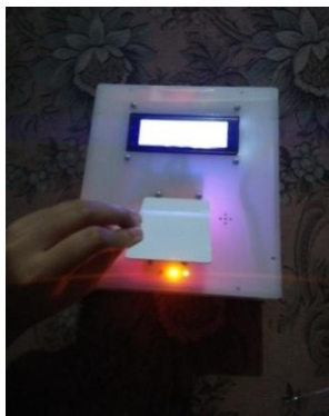
Cara Pengujian Kartu Posisi Miring Sisi Lebar 5,4 cm
