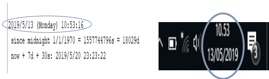
Hasil Pengujian RTC yang di Bandingkan dengan Taskbar Laptop
