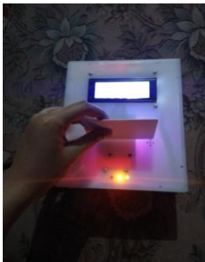
Cara Pengujian Kartu Posisi Tegak Sisi Panjang 8,5 cm
