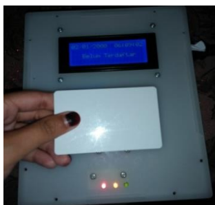
Gambar 4.40 Hasil Pengujian Led untuk Penanda Kartu yang Belum Terdaftar
