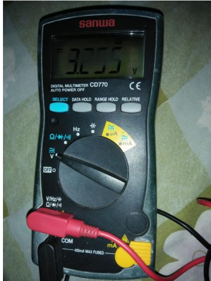
Gambar 4.10 Hasil Pengujian Modul Step Down pada Avometer
