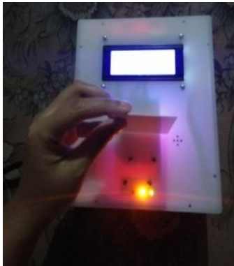
Cara Pengujian Kartu Posisi Tegak Sisi Lebar 5,4 cm
