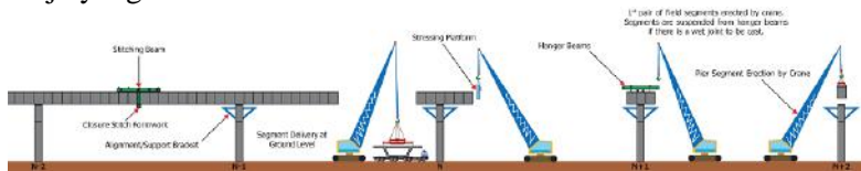
Gambar 2. 8 Metode balanced cantilever menggunakan crane (VSL International, 2012)
