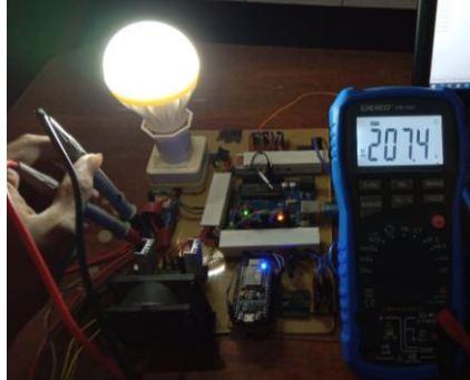
Gambar 3.6 Pengujian dan Kalibrasi Tegangan Sensor AC
