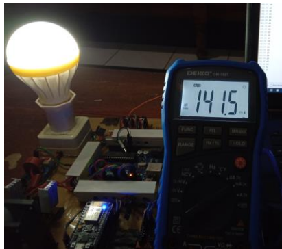
Gambar 3.7 Pengujian dan Kalibrasi Arus Sensor AC
