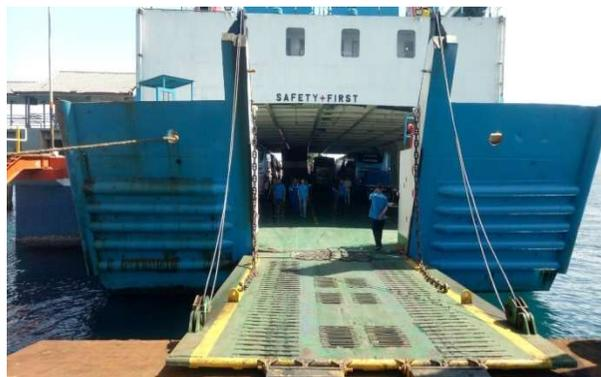
Gambar. 2.1 Kontruksi rampdoor yang terpasang
