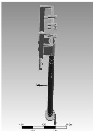
Gambar 4.7. Arah Pembebanan *Frame* poros dari  $0^{\circ}$
