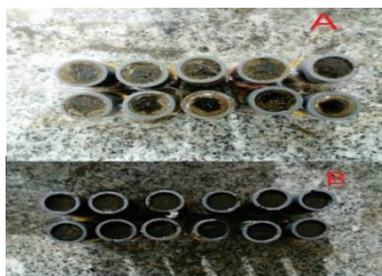
Gambar 4. 7 Proses pencetakan dan pemeraman pasta geopolimer pada cetakan silinder dengan abu layang (A) Indramayu dan (B) Asam-Asam
