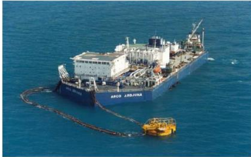
Gambar 2.4 Catenary Anchor Leg Mooring (CALM) pada FSO AA
