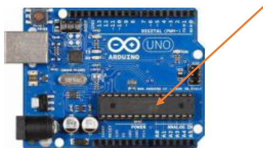
Gambar 2.19 Arduino UNO ( Microcontroller ATmega328 )
