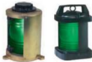
Gambar 2.5. Side light Starboard 112,5° Jarak tampak 3 mil (Sumber: Silvester Simau, A.Pi, S.Pi, M.Si. 2012)
