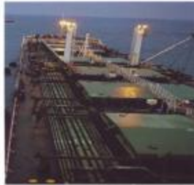
Gambar 2.14. Kapal yang panjang lebih dari 50 m harus memperlihatkan penerangan di deck , pada saat berlabuh jangkar.
