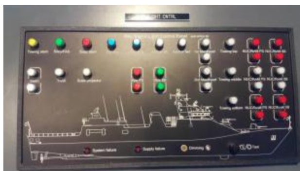
Gambar 4.3 Box Control Lampu Navigasi KRI Sampari 628
