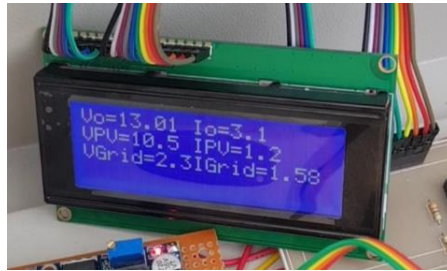
Gambar 4. 21 Monitoring LCD dari Solar Tracker dan Jala-jala Listrik
