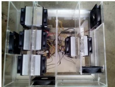
**Gambar 2. 14 Sistem Dehumidifier Termoelektrik Portable**
