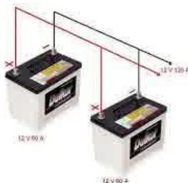
**Gambar 2. 7 Rangkaian Paralel Baterai**
