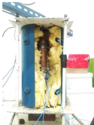
Gambar 3. 10 Gambar Pemasangan Spesimen pada Alat Uji
