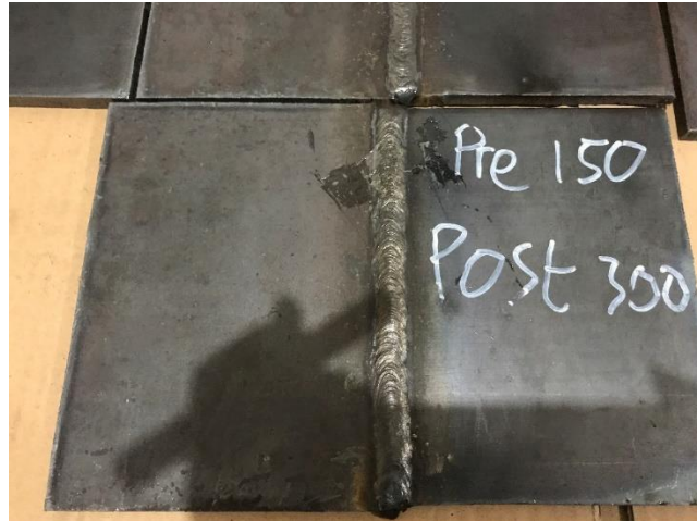
Gambar 4.14. Hasil Pengujian NDT Radiografi Spesimen dengan Perlakuan Preheating 150°C dan Postheating 300°C
