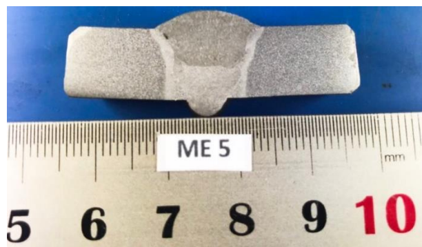
Gambar 4.28. Hasil Foto Makro pada Spesimen Dengan Perlakuan Preheating 150°C dan Postheating 200°C
