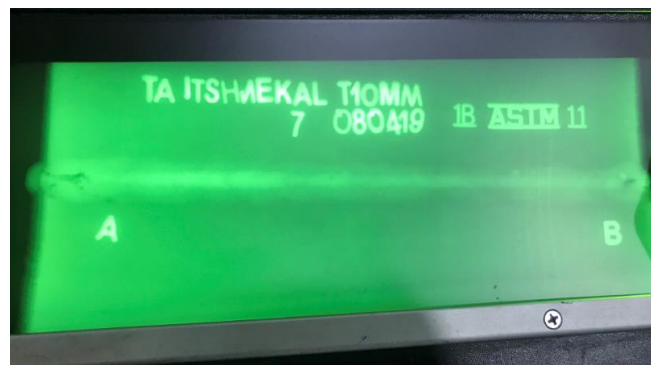
Gambar 4.5. Hasil Pengujian NDT Radiografi Spesimen dengan Perlakuan Preheating 100°C dan Postheating 200°C
