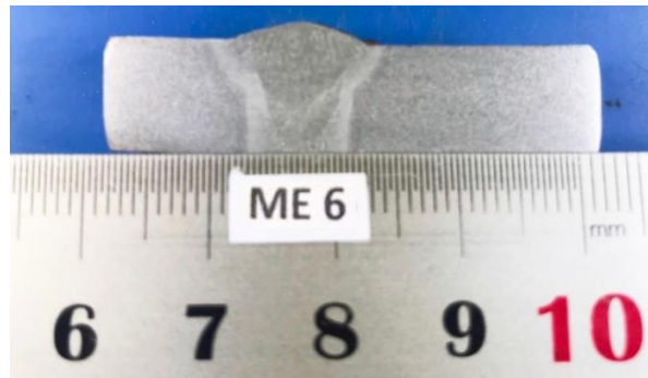
Gambar 4.24. Hasil Foto Makro pada Spesimen Tanpa Perlakuan PWHT
