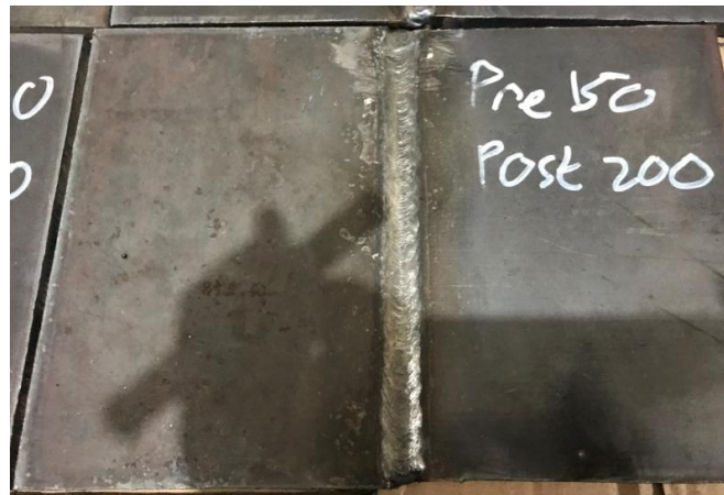
Gambar 4.10. Hasil Pengelasan Spesimen dengan perlakuan Preheating 150°C dan Postheating 200°C
