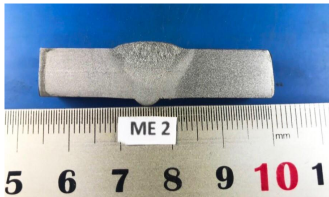
Gambar 4.26. Hasil Foto Makro pada Spesimen Dengan Perlakuan Preheating 100°C dan Postheating 250°C
