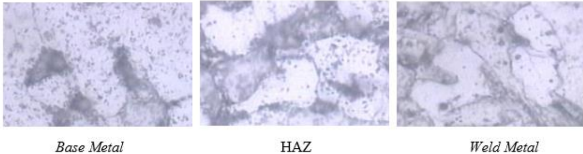
Gambar 4.33 Struktur Mikro Spesimen Preheating 100°C dan Postheating 200°C
