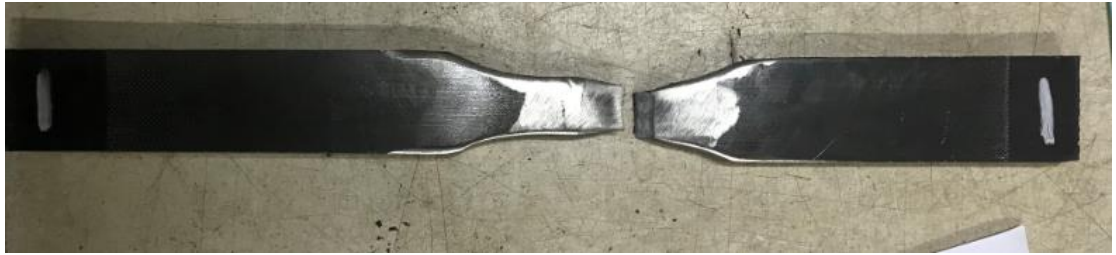
Gambar 4.21. Hasil Uji Tarik pada Spesimen Dengan Perlakuan Preheating 150°C dan Postheating 250°C
