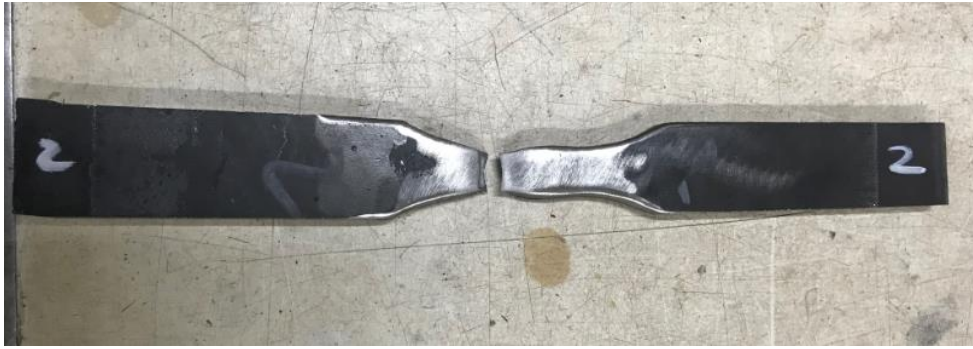
Gambar 4.18. Hasil Uji Tarik pada Spesimen Dengan Perlakuan Preheating 100°C dan Postheating 250°C
