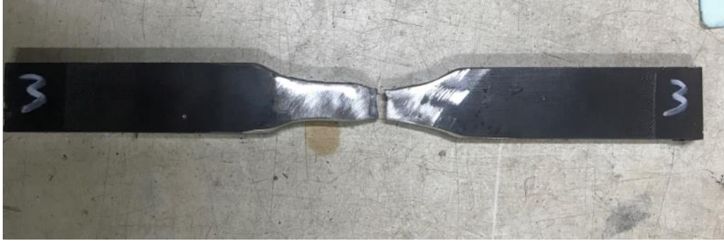
Gambar 4.22. Hasil Uji Tarik pada Spesimen Dengan Perlakuan Preheating 150°C dan Postheating 300°C
