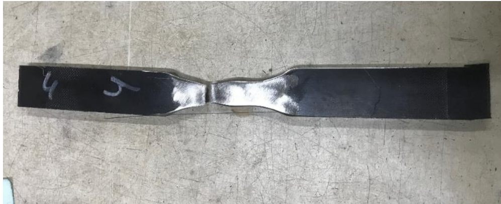
Gambar 4.19. Hasil Uji Tarik pada Spesimen Dengan Perlakuan Preheating 100°C dan Postheating 300°C
