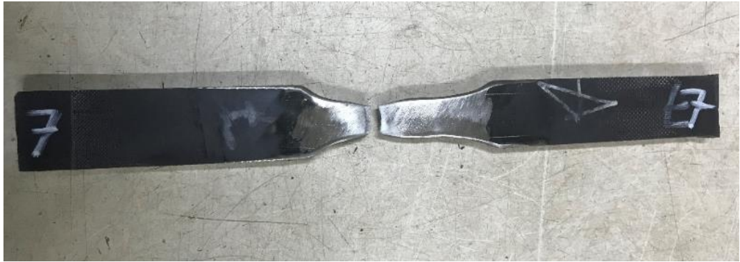
Gambar 4.17. Hasil Uji Tarik pada Spesimen Dengan Perlakuan Preheating 100°C dan Postheating 200°C
