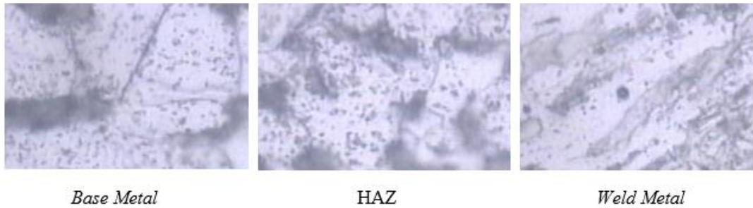
Gambar 4.34 Struktur Mikro Spesimen Preheating 100°C dan Postheating 250°C
