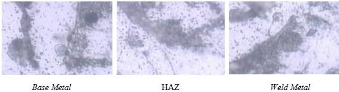
Gambar 4.37 Struktur Mikro Spesimen Preheating 150°C dan Postheating 250°C
