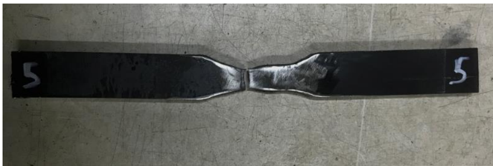
Gambar 4.20. Hasil Uji Tarik pada Spesimen Dengan Perlakuan Preheating 150°C dan Postheating 200°C
