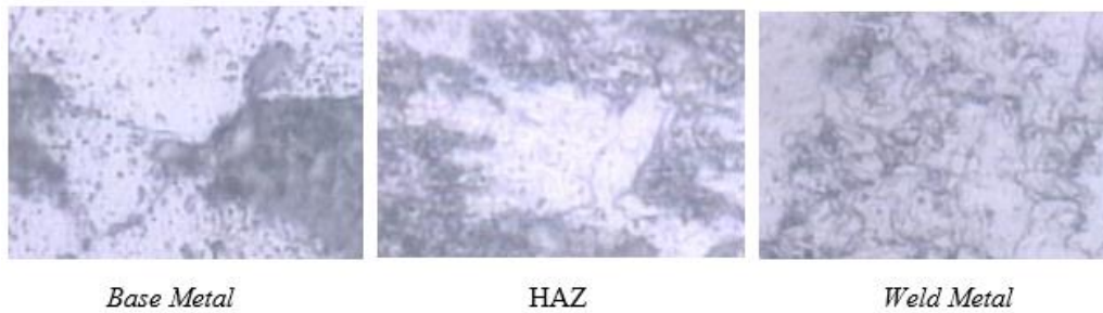
Gambar 4.35 Struktur Mikro Spesimen Preheating 100°C dan Postheating 300°C
