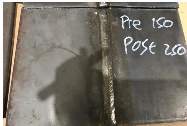
Gambar 4.12. Hasil Pengelasan Spesimen dengan perlakuan Preheating 150°C dan Postheating 250°C
