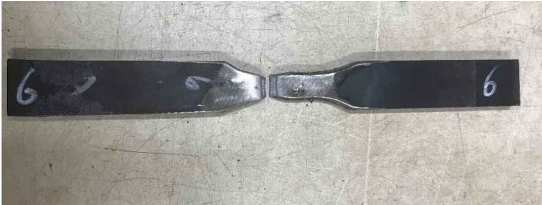
Gambar 4.16 Hasil Uji Tarik pada Spesimen Tanpa Perlakuan PWHT
