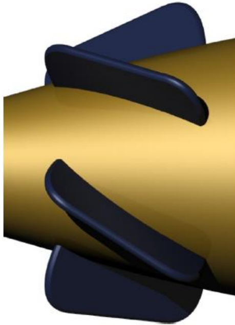
Gambar 2. 18. Model Propeller Boss Cap Fins (Sumber : Mizzi, 2017)
