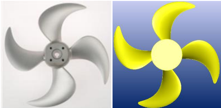
Gambar 2. 19. Model Propeller C4-40 dengan P/D 1.4 (Sumber : Suranto, 2018)
