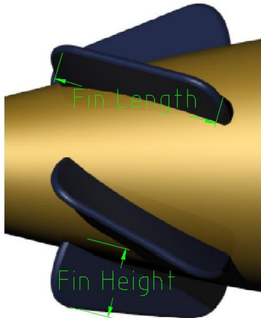
Gambar 2. 12. Geometri PBCF (Sumber : Mizzi, 2017)
