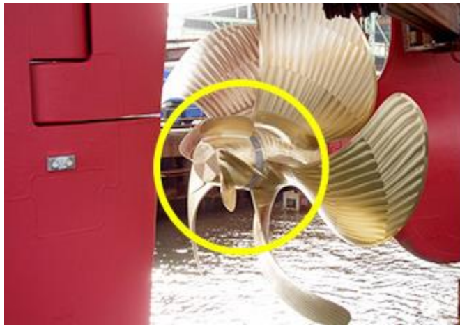
Gambar 2. 3. PBCF Sebagai Energy Saving Device (Sumber : www.mol.co.jp)
