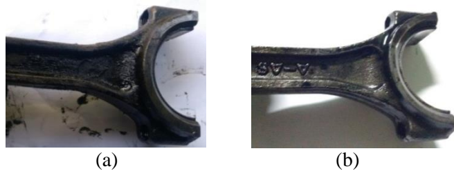
Gambar 4.1 Kondisi Connecting rod saat menggunakan (a) Biopelumas Minyak Jarak Kepyar (b) Pelumas Pertamina Mesran B SAE 40
