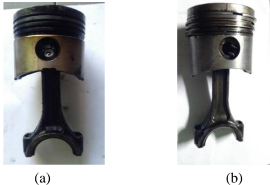
Gambar 4.3 Kondisi piston setelah eksperimen (a) Biopelumas Minyak Jarak (b) Pelumas Pertamina Mesran B SAE 40
