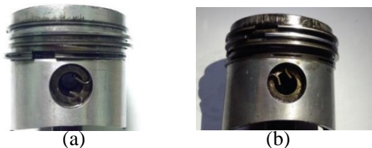
Gambar 4.6 Kondisi piston setelah eksperimen (a) Pelumas Pertamina Mesran B SAE 40 (b) Biopelumas Minyak Jarak Keypar
