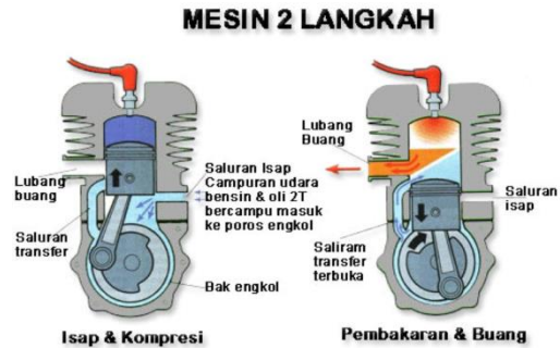
Gambar 2.3 Proses Kerja Mesin Diesel 2 Tak Proses dari mesin diesel 2 langkah mencapai satu proses usaha yaitu :
