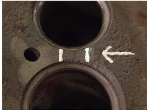
Gambar 2.15 Keretakan Pada Kepala Silinder Selain itu, keretakan pada kepala silinder dapat dikarenakan oleh panasnya mesin akibat kekurangan pasokan pendingin.
