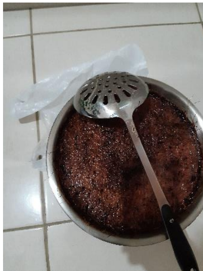
Gambar 3.9 Perendaman Spesimen dengan larutan NaOH
