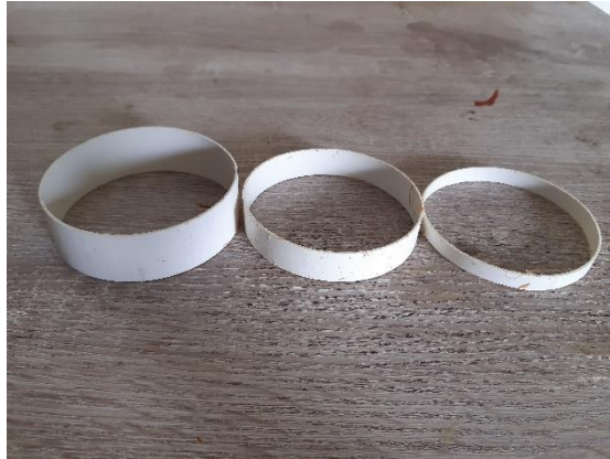
Gambar 3.12 Cetakan PVC dengan variasi tinggi 10mm, 20mm, dan 30mm
