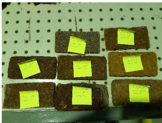
Gambar 3.14 Spesimen yang telah dicetak menggunakan cetakan akrilik
