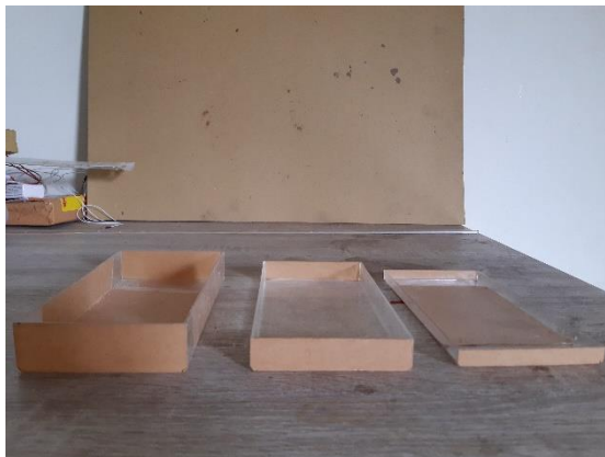
Gambar 3.11 Cetakan Akrilik dengan variasi tinggi 10mm, 20mm, dan 30mm
