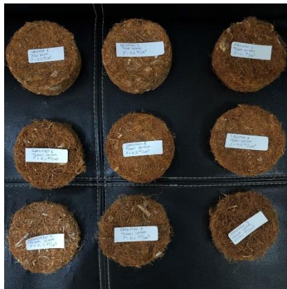
Gambar 3.13 Spesimen yang telah dicetak menggunakan cetakan PVC
