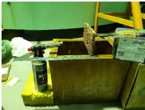
Gambar 3.19 Gambar Rangkaian Sistem Uji Perambatan Api
