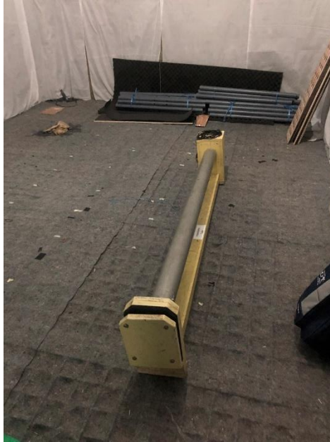
Tabung Impedansi yang Digunakan dalam Pengambilan Data
