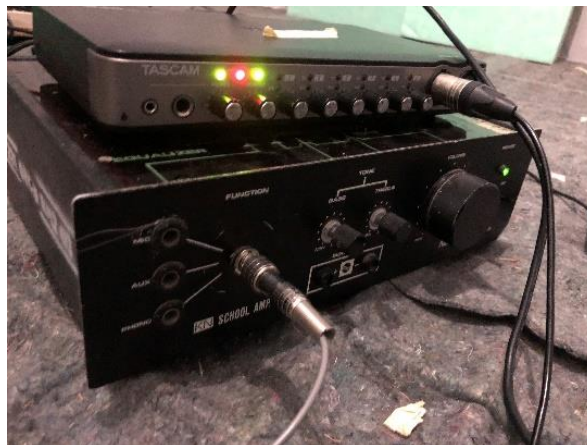
Gambar 3.13 Amplifier dan Audio Generator
