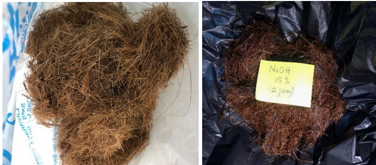
Gambar 4.3 Hasil Perendaman Serat Sabut Kelapa Sebelum dan Sesudah Perlakuan Alkali NaOH
