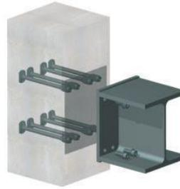
Gambar 4.16 Detail sambungan balok baja dengan kolom beton
