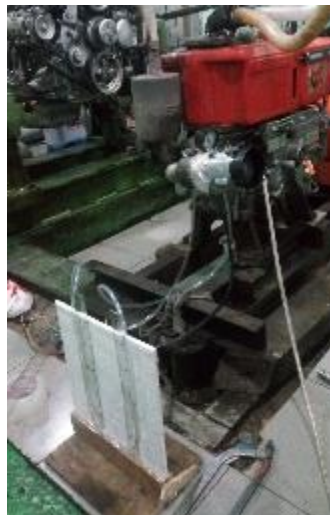
Gambar 3. 8. Engine Set Up Untuk Kapasitas udara menggunakan Electric fan
