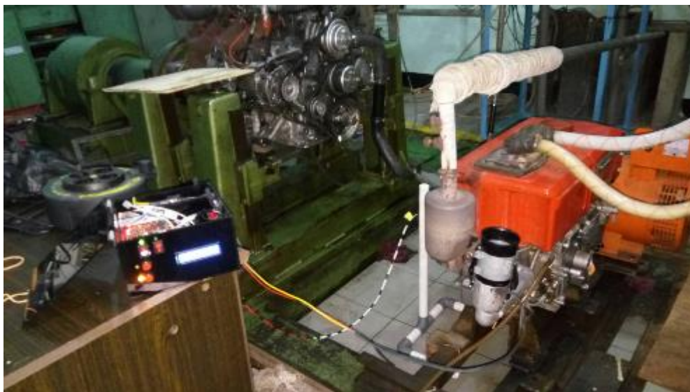
Gambar 3. 4. Sistem Electric Fan pada Intake Manifold
