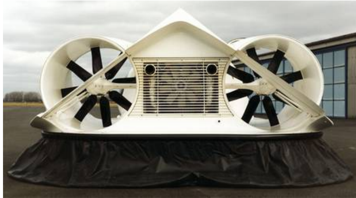
Gambar 2.11 Air propeller dengan jumlah 8 blade (Sumber: http://www.abs-hovercraft.com )
