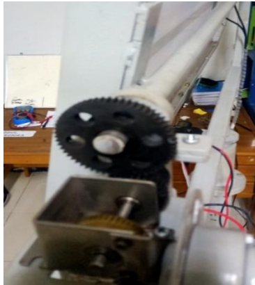
Gambar 3. 7 Pemasangan motor untuk sudut pitch
