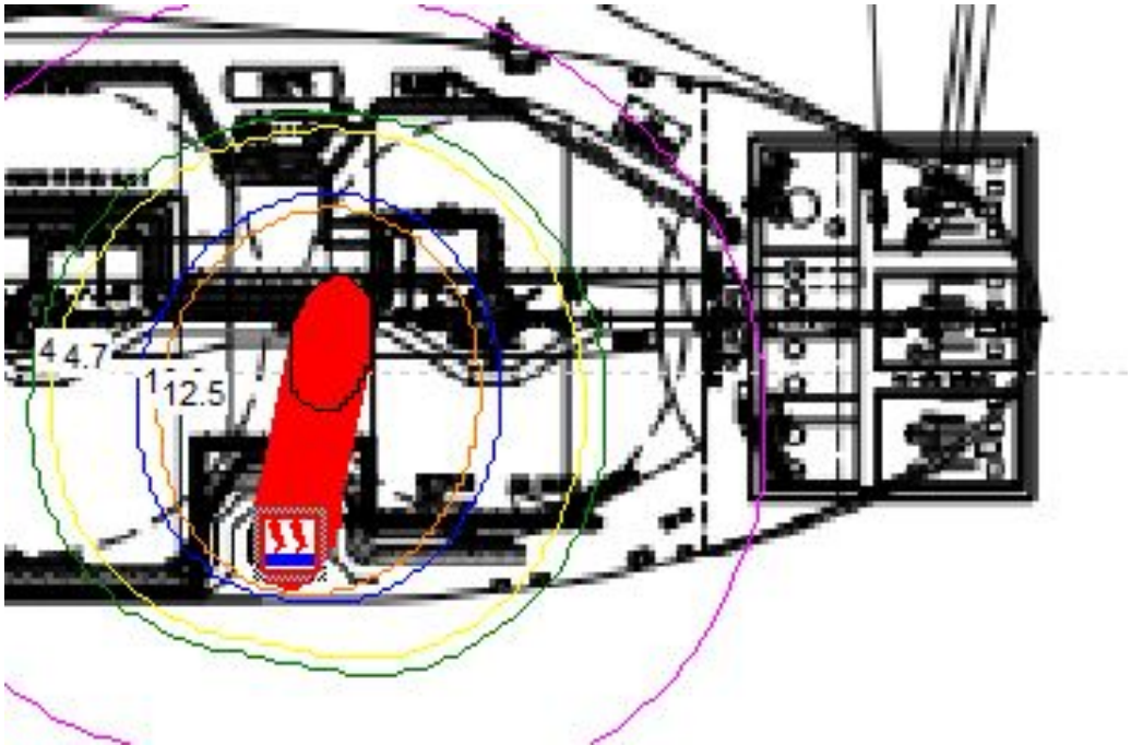
Analisa Konsekuensi Flash Fire Node 5 skenario 10-50mm – Day Time Top View
