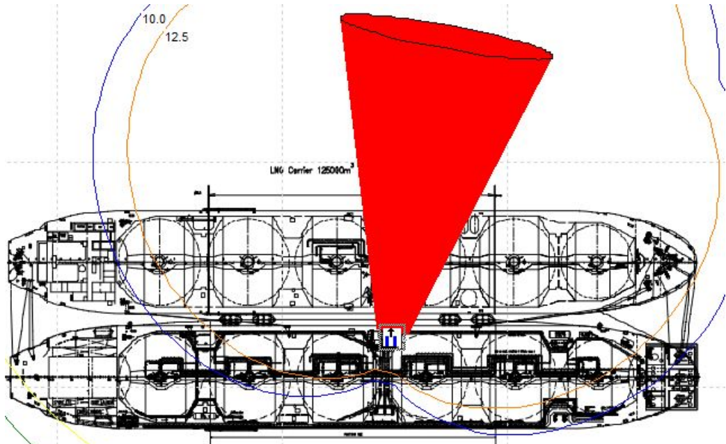
Analisa Konsekuensi Jet Fire Node 1 skenario >150mm – Day Time Top View
