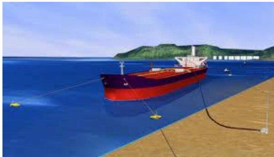
Gambar 1.1 FSO dengan Flexible Riser (Sun Liping, 2011)
