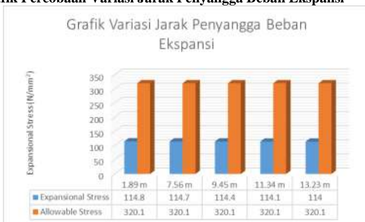
Gambar 4.16. Grafik Percobaan Variasi Jarak Penyangga Beban Ekspansi
