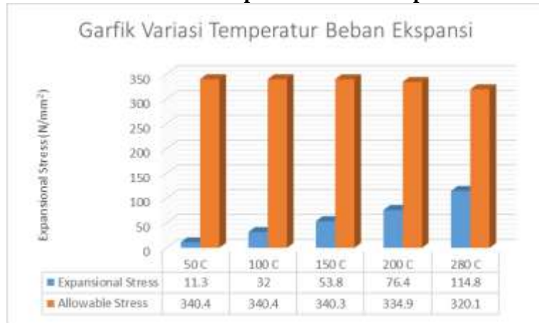
Gambar 4.14. Grafik Percobaan Variasi Temperatur Beban Ekspansi
