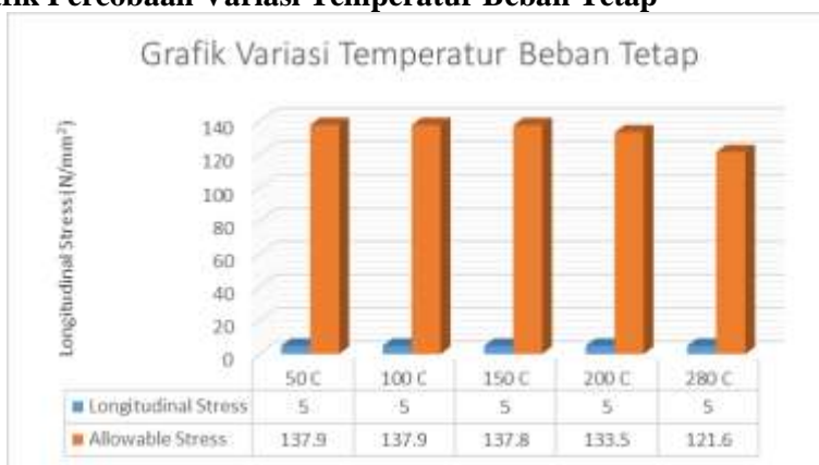
Gambar 4.13. Grafik Percobaan Variasi Temperatur Beban Tetap
