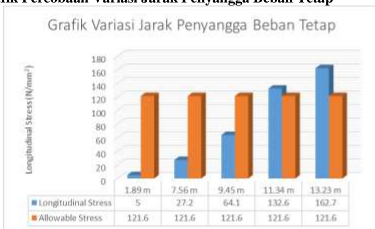
Gambar 4.15. Grafik Percobaan Variasi Jarak Penyangga Beban Tetap
