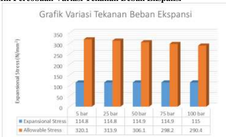
Gambar 4.12. Grafik Percobaan Variasi Tekanan Beban Ekspansi
