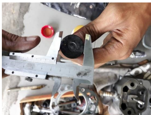
Gambar 3.7 pengukuran pada valve
