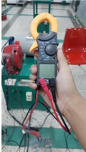
Gambar 3. 13 Tang meter/*clamp meter* untuk mengukur arus dan tegangan
