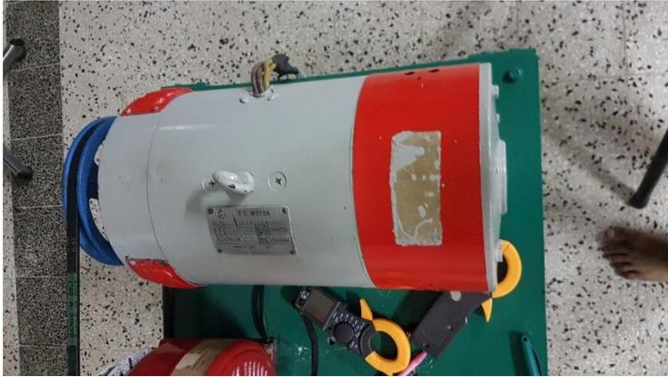
Gambar 3. 7 Motor dc sebagai penggerak untuk generator thruster
