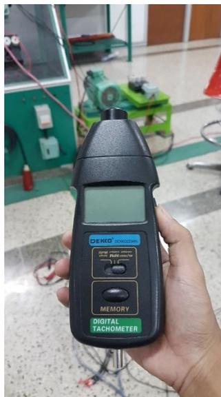
Gambar 3. 14 Tachometer untuk mengukur putaran motor dan generator
