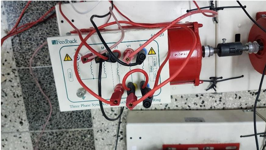
Gambar 3. 4 hree phase sync/async motor/generator-slip ring sebagai pembangkit untuk beban thruster
