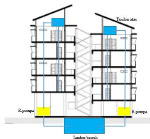
Gambar 4.8 Utilitas air bersih (Sumber: Dokumentasi Pribadi, 2019)
