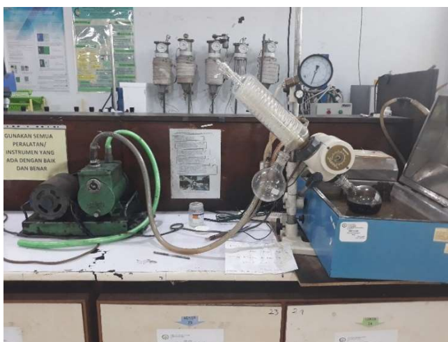
Gambar 3.4. Proses Evaporasi Menggunakan Rotary Evaporator
