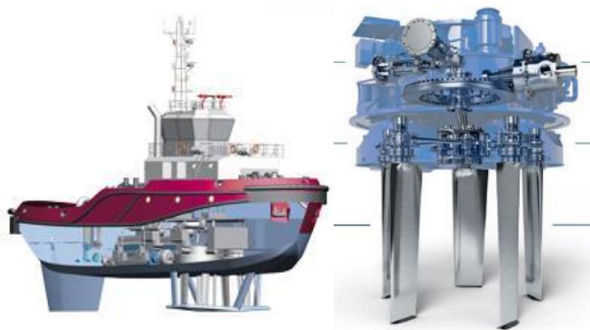
Gambar 2.7 Voith Schneider Propeller (VSP)
