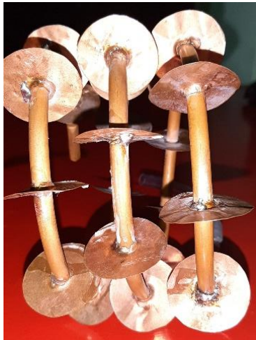
Gambar 2. 6 Pipa Tembaga dengan Circular Fin
