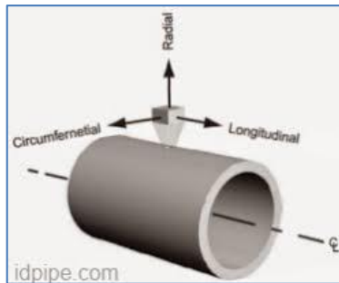
Gambar 2.9 Stress pada pipa
