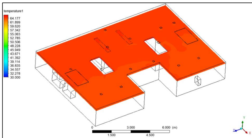
Gambar 4. 23 Kondisi suhu kamar mesin pada saat ducting off (1,5 meter)
