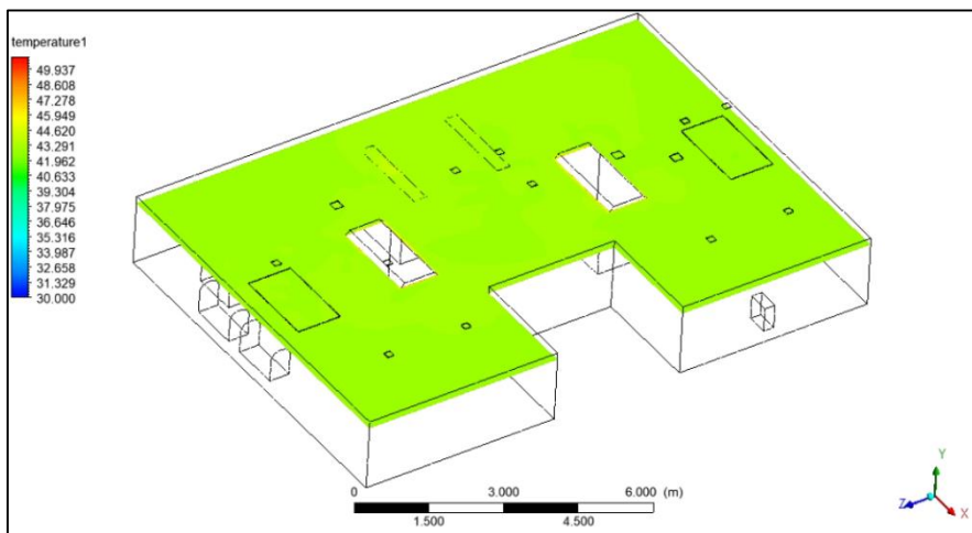
Gambar 4. 35 Kondisi suhu kamar mesin variasi 2 (1,5 meter)
