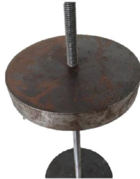
Gambar 4. 1 Besi dan ulir di dalam lambung model SPAR
