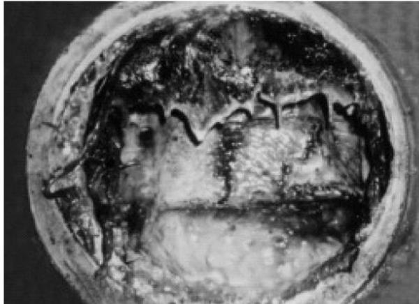
Gambar 2.3 Lapisan Film yang Terbentuk pada Pipa Bahan Bakar ( sumber : Siegert, 2013)
