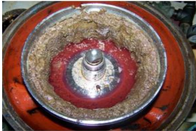
Gambar 2.13 Deposit pada Separator Bahan Bakar (Sumber : Fattah dkk, 2013)
